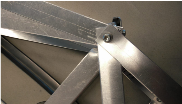
Figuur 7.2 Het tweede punt waarop de davit is bezweken.
